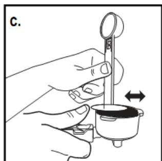
После наполнения фильтра необходимо тщательно и равномерно утрамбовать кофе. Все излишки кофе следует удалить. Это обеспечит правильную фиксацию фильтра на головке группы.
